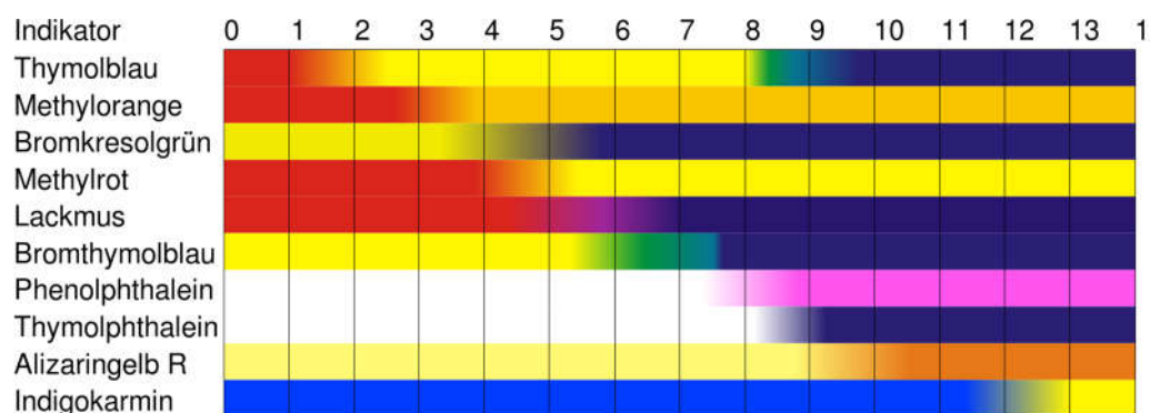
Abbildung 1: Farbspektren der Indikatoren. Jeder Indikator besitzt mindestens zwei Farben. Je nach Indikator kommt der Farbumschlag bei unterschiedlichen pH-Werten vor. Beispielsweise liegt der Farbwechsel bei Phenolphthalein bei einem pH-Wert von ca. 7,5 (vgl. [Abb.1]).
